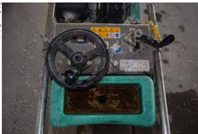
Panel przedni ze zbiornikiem na wodę, kierownicą ruchu posuwistego oraz korbką do ustawiania głębokości cięcia i blokadą
