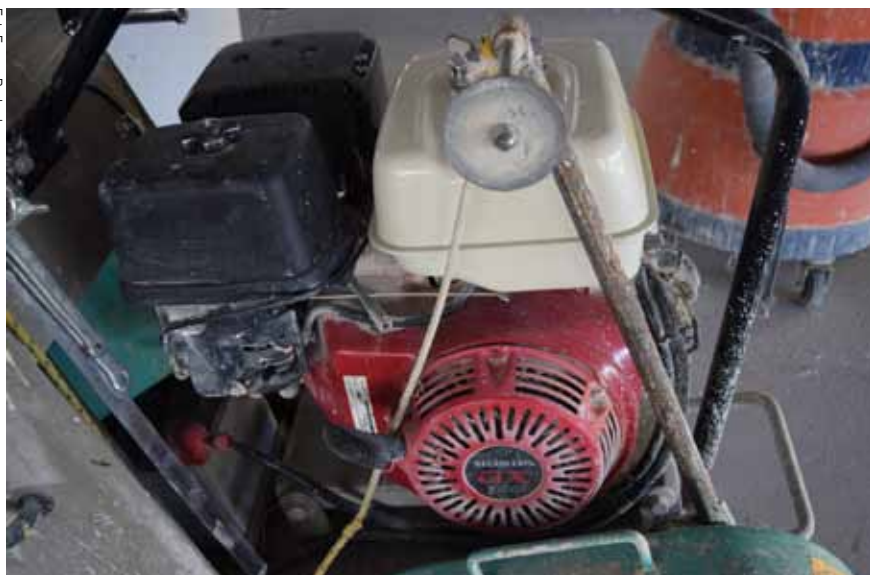
Mikasę MCD-218CEH napędza niezawodny silnik Honda GX390 o mocy 11 KM. Konstrukcja maszyny jest przewymiarowana tak, aby „przeżyć” trzy takie jednostki
