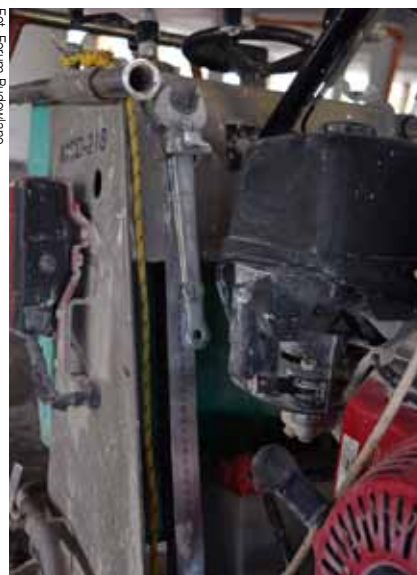
Klucze i przymiar niezbędne podczas wymiany tarczy są zawsze pod ręką
