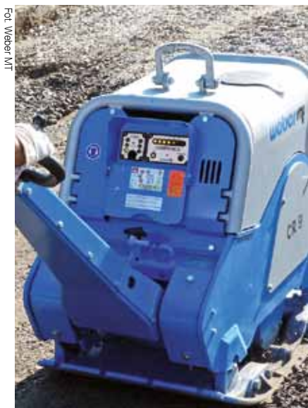
Tyłny panel zagęszczarki Weber CR 9 – widoczne panele Compatrol i MDM (z lewej)
