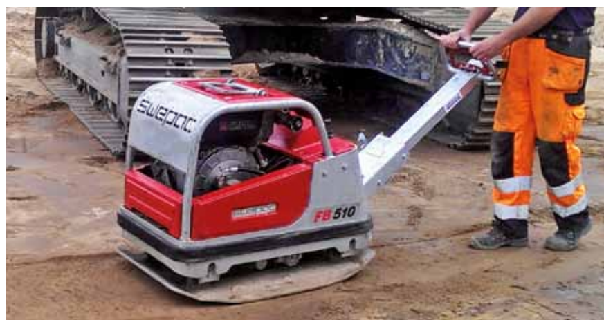
Hydrauliczna zagęszczarka rewersyjna do gruntu FB510 podczas pracy
