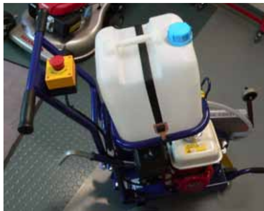
Przecinarka Sharky 351 zastąpiła model 350. Wyposażono ją w mocniejszy silnik GX200. Na zdjęciu obok zbliżenie na czerwono-żółty wyłącznik bezpieczeństwa, który w przypadku awarii natychmiast wyłącza silnik
