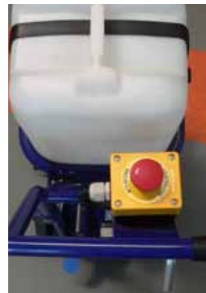
Przecinarka Sharky 351 zastąpiła model 350. Wyposażono ją w mocniejszy silnik GX200. Na zdjęciu obok zbliżenie na czerwono-żółty wyłącznik bezpieczeństwa, który w przypadku awarii natychmiast wyłącza silnik
