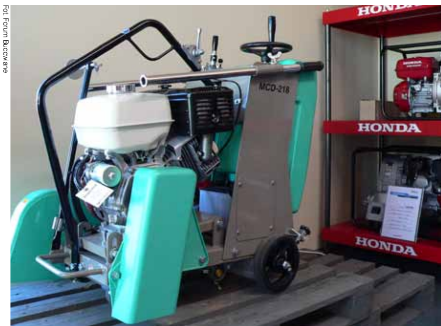
Przecinarka Mikasa MCD-218CEH w całości produkowana jest w Japonii. Widoczny hamulec postojowy na tylnym kole, a na zdjęciu obok zbliżenie na elektryczny rozrusznik
