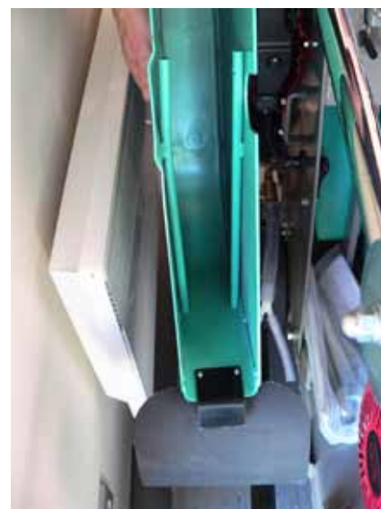
Uniesiona osłona tarczy tnącej. Tarcza chłodzona jest z obydwu stron poprzez system podwójnych rurek
