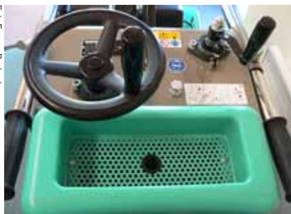
„Pulpit sterowniczy” przecinarki MCD-218CEH: widoczne koło ręcznego posuwu i korbka do regulacji głębokości z blokadą
